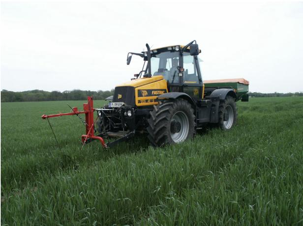
Bild 2: Sensor in Kombination mit einem Zentrifugal-Düngerstreuer für die Stickstoffdüngung
