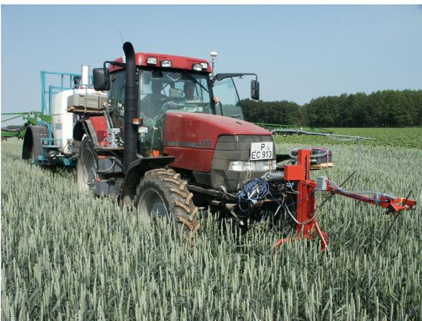
Bild 3: Sensor in Kombination mit einer Feldspritze für den Pflanzenschutz
