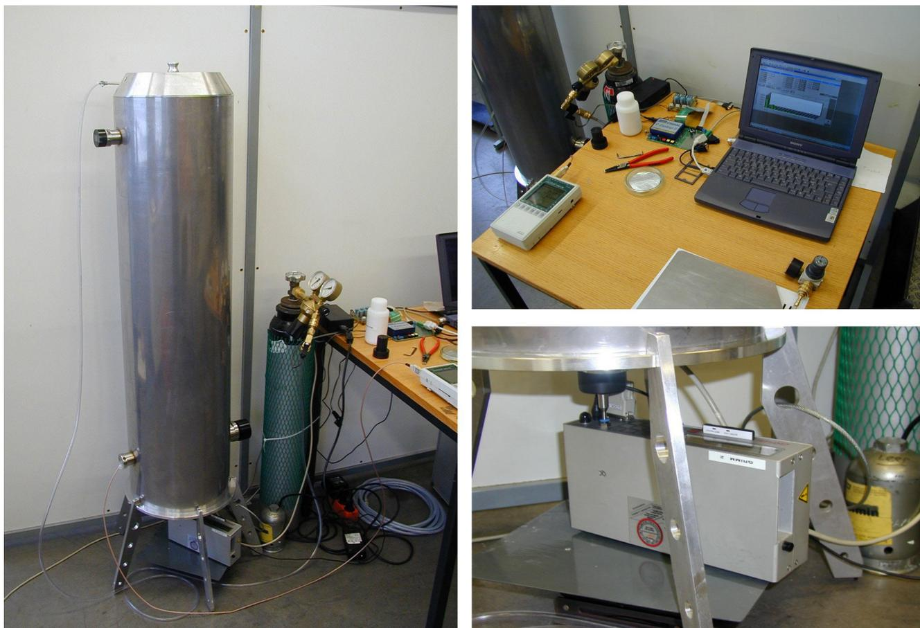
**Bild 2:** Sedimentationszylinder (links) mit Datenerfassung (rechts oben) und Aerosolspektrometer (rechts unten)
