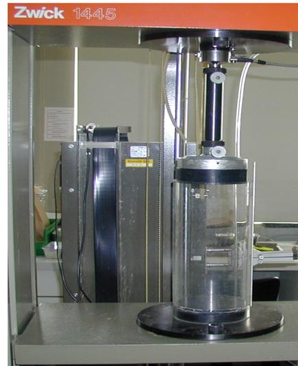
Abb. 2: Materialprüfmaschine zur Prüfung der Verdichtbarkeit von gequetschtem Feuchtgetreide
