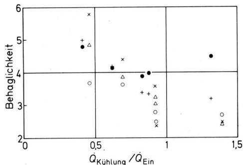
Bild 14. Subjektive Behaglichkeit in Abhängigkeit vom Wärmestromverhältnis  $\dot{Q}_{\text{Kühlung}}/\dot{Q}_{\text{Ein}}$  (Kühlleistung der Zuluft/Wärmestrom durch Sonnenstrahlung und von Motor und Getriebe) bei verschiedenen Arten der Zuluftzuführung.
