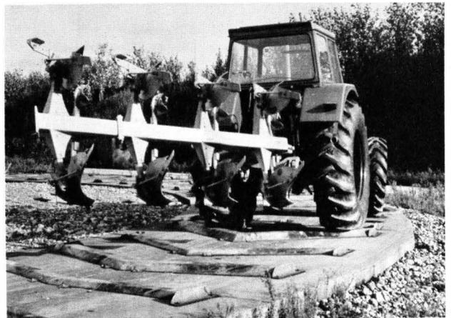
**Bild 19.** Prüfung eines Schleppers mit schwerem Anbaugerät auf der Hindernisbahn.
