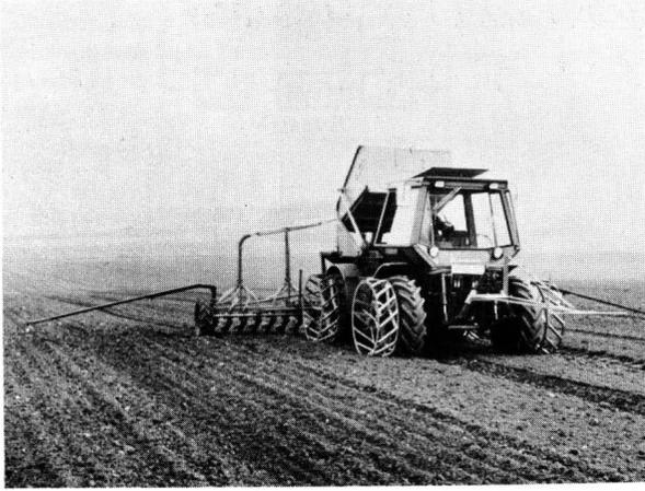
**Bild 17.** Systemfahrzeug INTRAC 2005 (68,5 kW) bei der Getreideaussaat.
