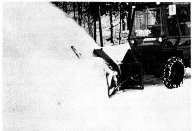
Bild 16. Systemfahrzeug INTRAC 2002 (37,5 kW) mit Schneeschleuder.
