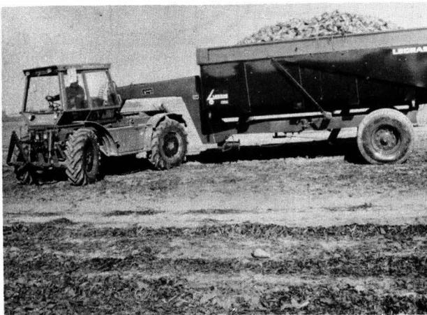
**Bild 18.** Systemfahrzeug INTRAC 2005 beim Rübentransport mit Kipp-Aufsattelanhängen.
