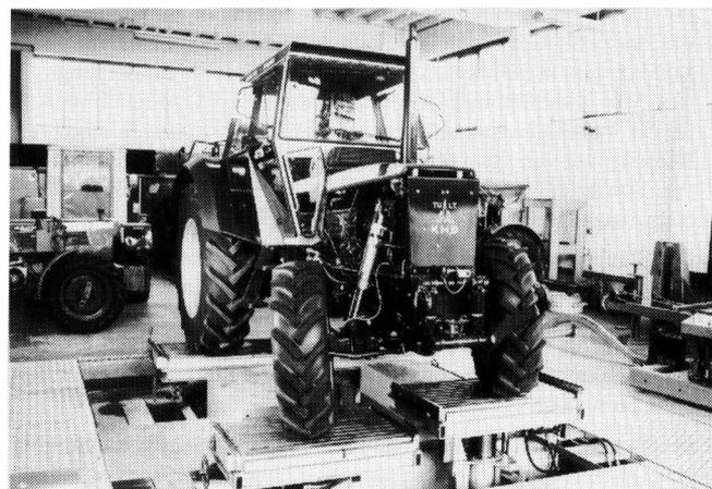
**Bild 7.** Standardschlepper nach Einbau einer hydropneumatischen Vorderachsfederung auf einer 4-Stempel-Hydropulsanlage.
