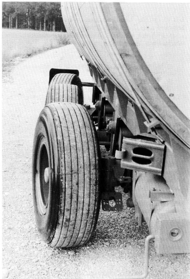
Bild 9. Rechte Fahrwerksseite eines Gülletankwagens mit 20 t zulässigem Gesamtgewicht mit nachlaufgelenkten Rädern der ersten und dritten Achse.
