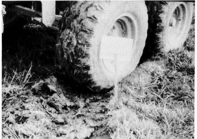
Bild 2. Tandemachsfahrwerk eines Gülletankwagens mit 8 t zulässigem Gesamtgewicht beim Wenden auf Grünland.
