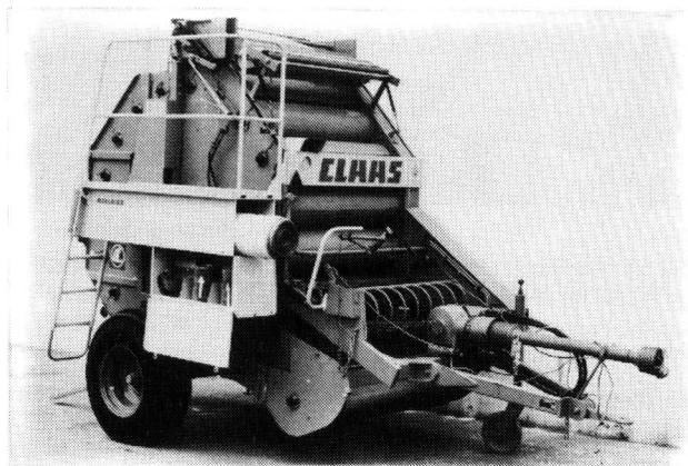
**Bild 9.** Rundballenpresse Claas-Rollant mit Rollatexbindung.
