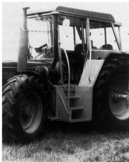
**Bild 15.** Ergonomisch günstig gestalteter und sicherer Schlepperaufstieg; Umbau.
