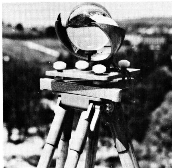
Bild 5. Gerät "Heliograph" zur Messung der Wellenlängen der Sonnenstrahlung.
