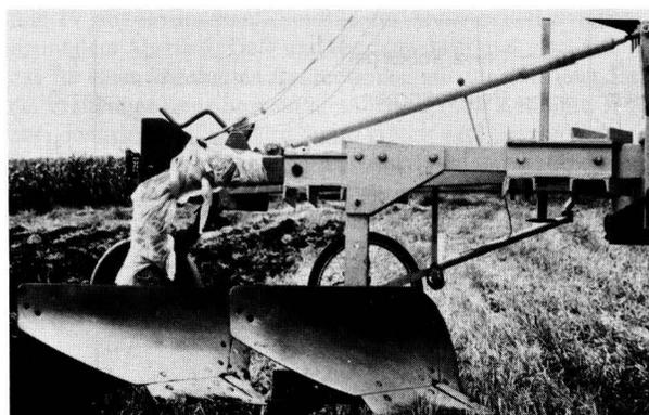
Bild 13. Zweischar-Meßpflug mit Rautenpflugkörpern; Meßgrindel mit Kunststoffolie abgedeckt.
