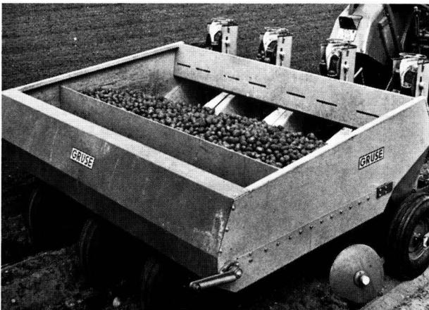
Bild 2. Vierreihige angehängte Legemaschine mit Rollbodenbunker (Gruse).
