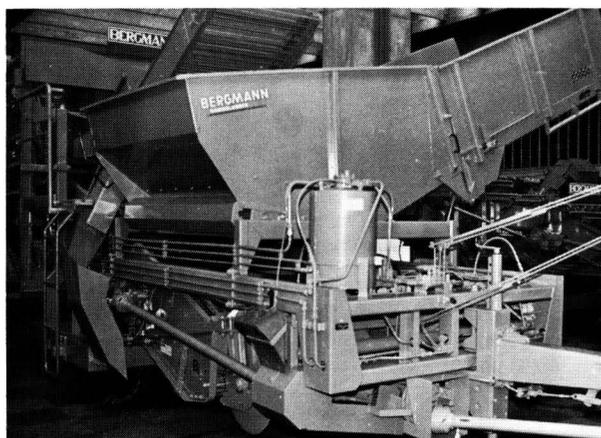
**Bild 8.** Hohe Anbringung des Rollbodenbunkers (Bergmann).
