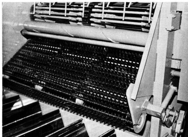
**Bild 6.** Kombination von gegenlaufendem Trennband und Zupfwalze (Niewöhner).
