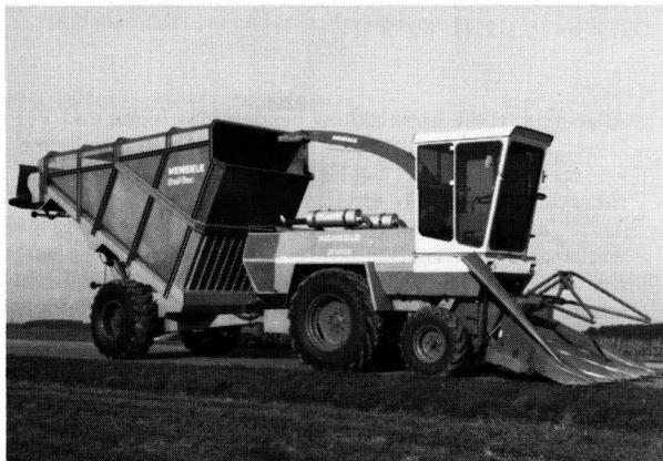
**Bild 6.** Selbstfahrender Feldhäcksler mit 4reihigem Maisgebiß, hydrostatischem Fahrtrieb, 196 kW. (Werkbild: Fa. Mengele)
