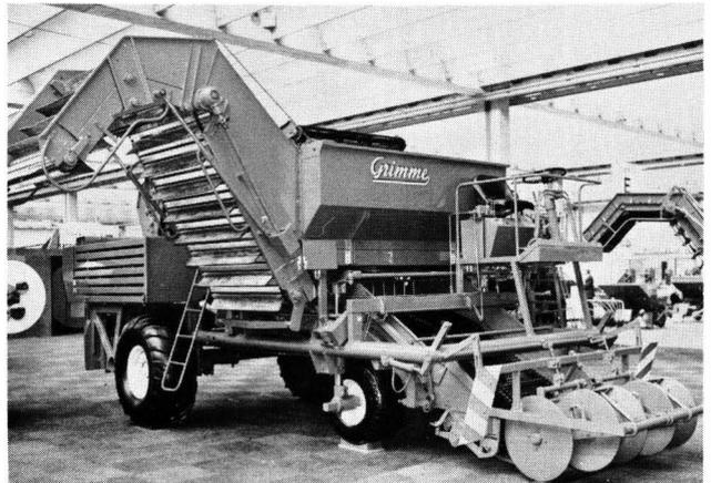
Bild 6. Zweireihiger Selbstfahrer mit Aufbaumotor.
