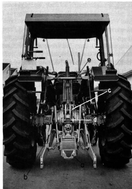
Bild 1. Schlepper mit automatischem Kuppelsystem.
