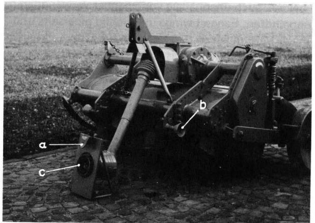
**Bild 4.** Gerät für den Dreipunktanbau mit Zapfwellenantrieb umgerüstet auf das automatische Kuppelsystem.
