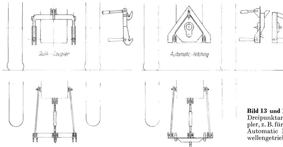
**Bild 13 und 14.** Amerikanischer Dreipunktanbau mit Quik-Coupler, z. B. für Pflüge, und mit der Automatic Hitching für zapfwellengetriebene Anbaugeräte.
