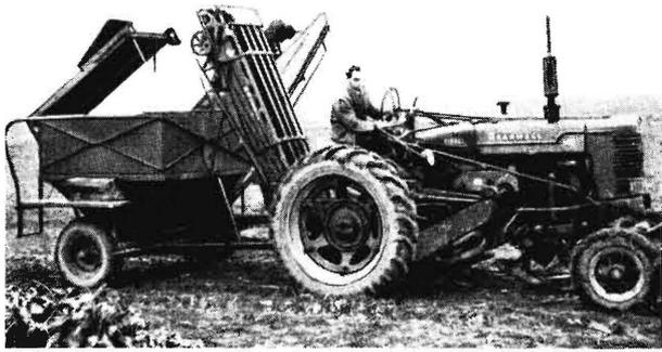
**Bild 12.** Amerikanische Anbau-Rübenerntemaschine mit nachlaufendem Bunkerkarren.
