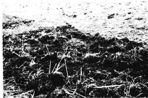
**Bild 8 bis 10.** Bodenoberfläche nach der Bearbeitung mit dem schwingenden Grubber bei einer Fahrgeschwindigkeit von 0,4, 0,6 und 0,8 m/s.
