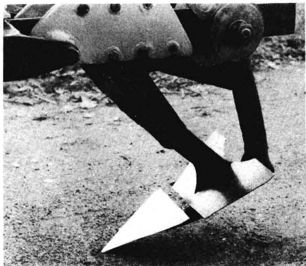
**Bild 2.** Schwingender Häufelkörper (B) mit zwei gegeneinander schwingenden, ebenen Körperteilen.
