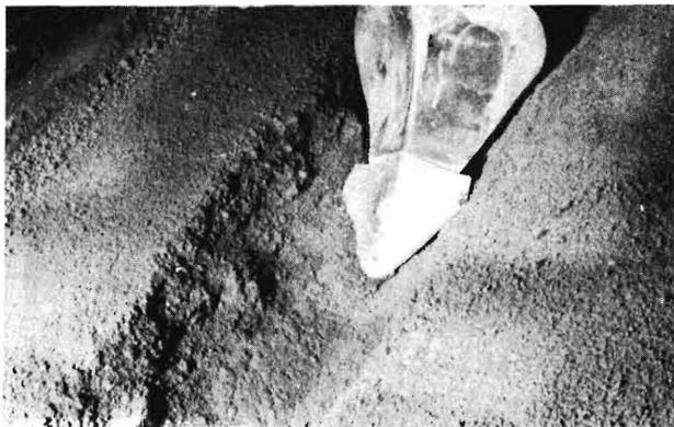
**Bild 29.** Dammlanken beim starren Häufelkörper der Form A. Verschmierte Furchenwand, dort wo das Schar gearbeitet hat.
