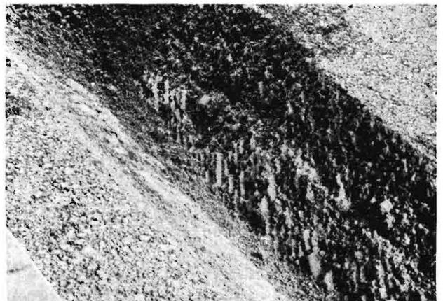
Schnittflächen sich mit Scherflächen abwechseln (Bild 30 bis 32). Allerdings tritt durch die keilförmige Form des Schar bei der Schnittbewegung eine gewisse Verdichtung auf. Sie beträgt bei 14 Hz nur etwa 30% der Bodenoberfläche, bei 20 und 30 Hz dagegen 40 bis 60%.
