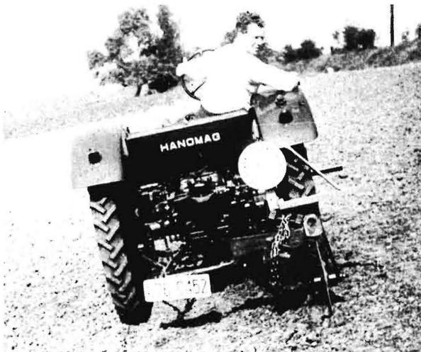
**Bild 10.** Schlepper mit einer Scheibenseche hinter dem rechten Schlepperhinterrad zur Verbesserung der Seitenführung am Hang und einer Messeinrichtung zum Ablesen des Einschlagwinkels der Vorderräder.
