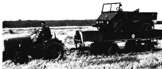
Abb. 3: Fahrwiderstandsmessungen auf einem Stoppelfeld. Der Unimog dient als Belastung des Anhängers
