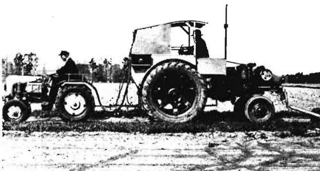
Bild 1: Versuchsschlepper und Bremszugwagen
