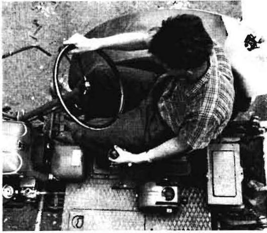
Bild 2: Gut erreichbarer Getriebeschalthebel neben dem Fahrersitz
