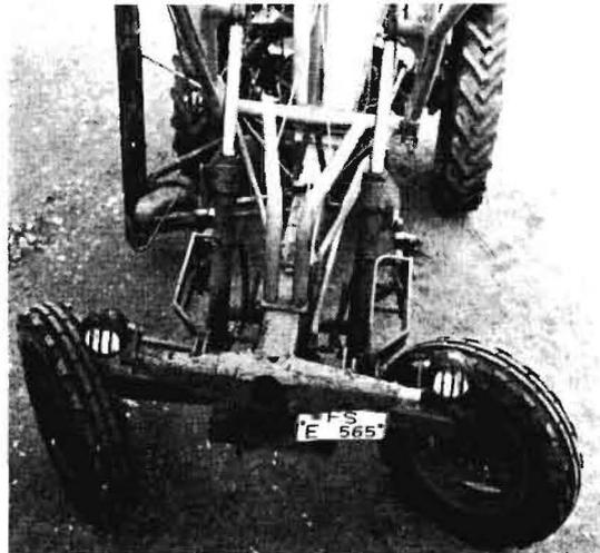
Bild 6: Starker Einschlag der Vorderräder ergibt einen kleinen Wendekreisdurchmesser
