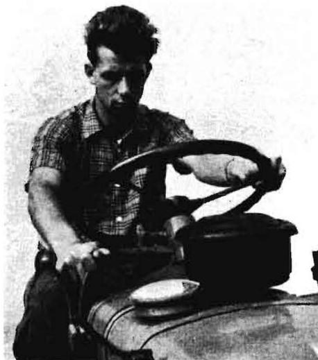
Bild 7: Gut erreichbares Hydrauliksteuerventil in Lenkradnähe und in Blickrichtung
