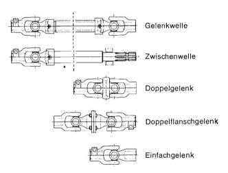
Gelenk- und Zwischenwellen können starr oder teleskopartig ausziehbar geliefert werden. Eine Kombination von Gelenkwelle und Zwischenwelle ergibt den Gelenkwellenstrang zur Überbrückung großer Längen und Vermeidung zu starker Beugewinkel.
