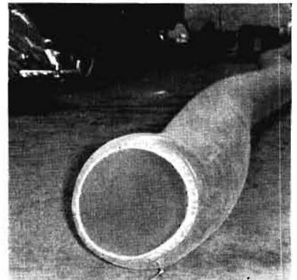
Bild 5c: Drosselung direkt am Schlauch durch Querschnittsverengung mit Hilfe eines eingelegten, dehnbaren Kunststoffringes
