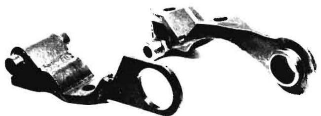
**Bild 4: Zugelement an einem landwirtschaftlichen Arbeitsgerät**
