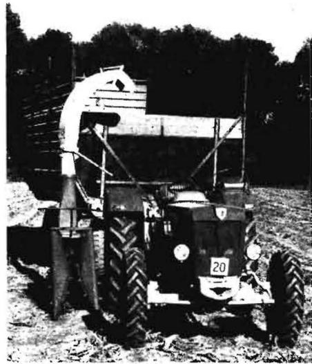
Bild 6: Einbau-Trommel-Feldhäcksler in Welkgut (siehe Bild 3 b) Ausleger anklappbar (Werkbild)
