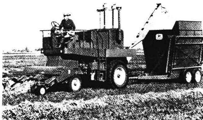
Bild 10: Aufsammel-Brikettiermaschine für Normaldruck-Briketts (Werkbild John Deere)
