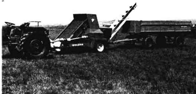
Bild 11: Aufsammel-Brikettiermaschine für Wickelbriketts (Werkbild Welger)
