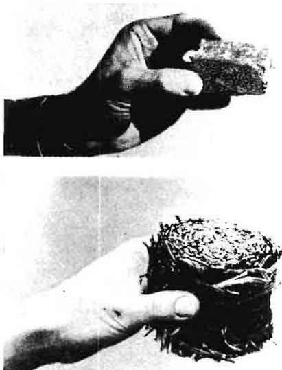
Bild 8: Vergleich zwischen Normaldruck-Brikett (oben, 32 × 32 × 60 mm) und Wickelbrikett (unten, 90 mm Ø, 60 mm lang)
