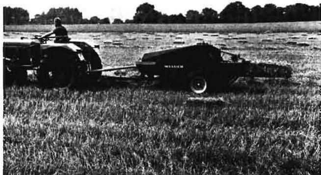
Bild 5: Kleine Aufsammelpresse mit Kanalschnitt 30 × 40 cm
