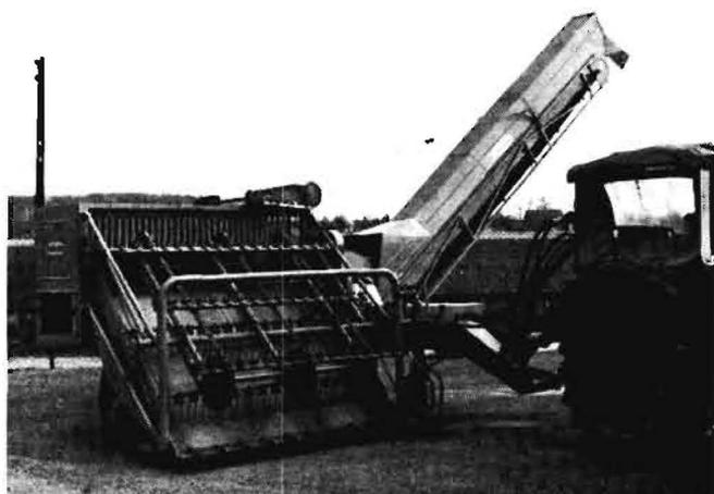
Bild 3: Anhängers-Schneidlager für die Ernte von Spinat (Werkbild Dreyer, Wittlage)
