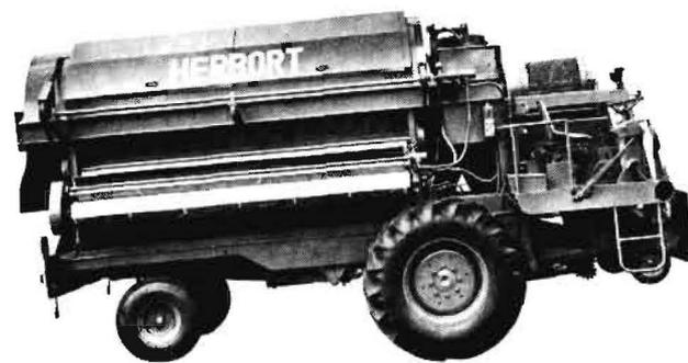
Bild 7: Selbstfahrende Erbsendreschmaschine (Werkbild Herborn, Braunschweig)
