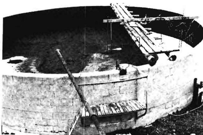
Bild 13: Anordnung der Meßstellen im Behälter für eine Temperaturmessung
