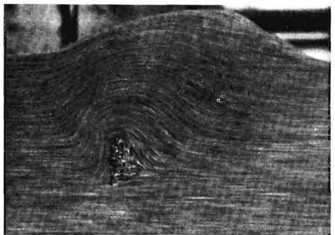
**Bild 10: Gleitlinien von Bodenpartikeln relativ zum Werkzeug und stationärer Bodenkeil vor dem Werkzeug**
