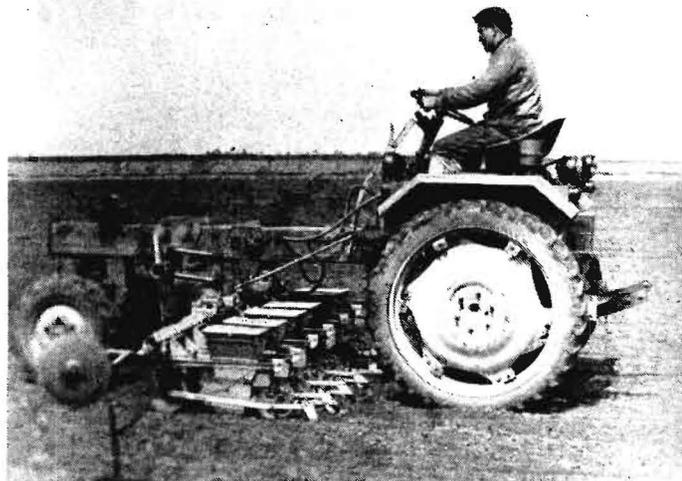
Bild 1. Einzelkornsämaschine A 765 für den Zwischenachs-anbau am RS 09
