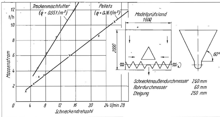
Bild 4. Abhängigkeit des Massenstromes von der Schneckendrehzahl
