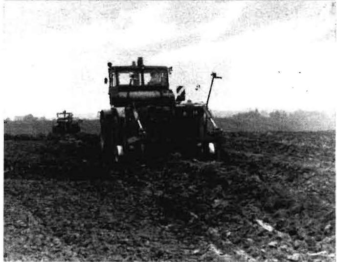
Bild 7. Lockerungskomplex bei der meliorativen Tieflockering auf gepflügtem Acker
