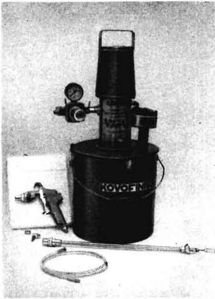
Bild 1. Hochdruckspritzgerät VYZA 2 (ČSSR)
