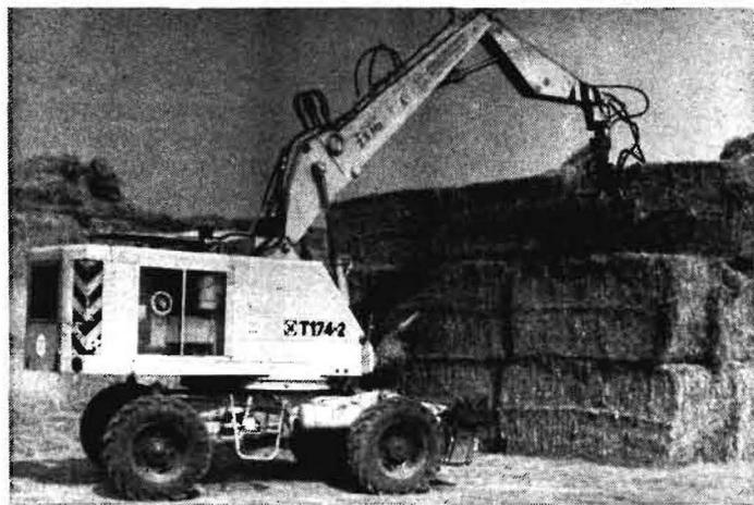
Bild 6. Ballenumschlag mit Mobilkran T 174-2 mit Drehkopf und Zinkenleiste
