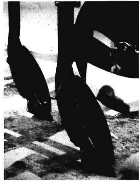
Bild 6. Spezielles Doppelherzschar eines Schwergrubbers der Fa. Rau (BRD)
