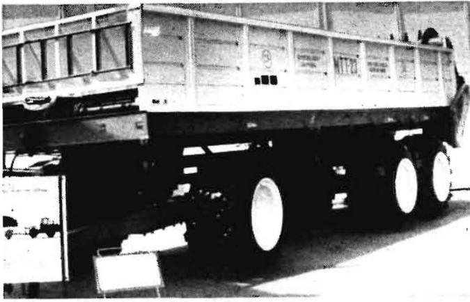
Bild 5. Stallungstreuer MTT-23 (UdSSR) mit Breitreifen; Nutzmasse 24 t, Streubreite 5,5 bis 8 m, für die Traktoren K-701 und K-710
