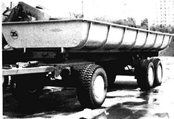
Bild 10. Anhänger zum Tomatentransport PTT-8 aus der VRB; Nutzmasse 9,6 t
