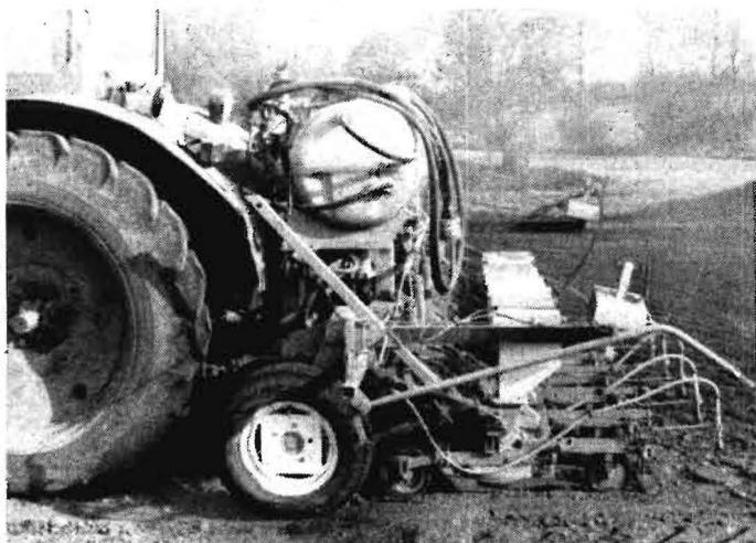
Bild 2. Einzelkornsämaschine A 600 mit Bandspritzeinrichtung (Werkfoto)
