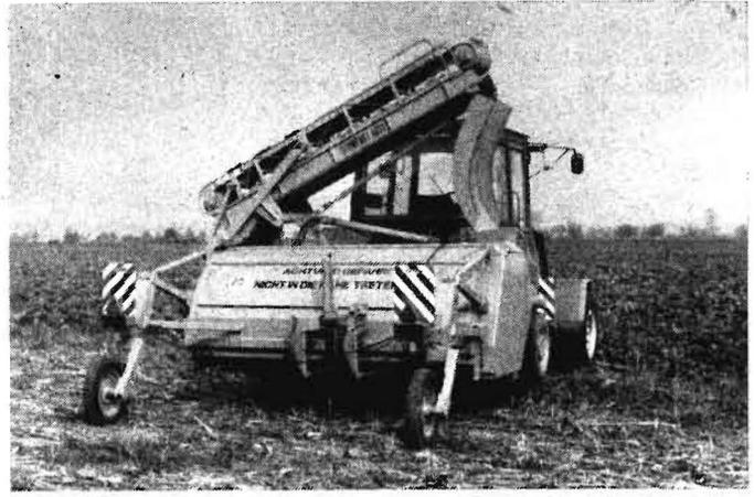
Bild 2. Köpfladerodeschwader KLR-S-F6/270 in Transportstellung
