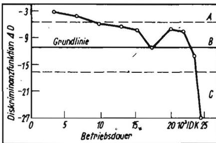
Bild 4. Abnutzungsverlauf für einen Dieselmotor Z-8011; A Bereich des sicheren Betriebs, B Bereich einer eingeschränkten Betriebssicherheit, C Bereich hoher Ausfallwahrscheinlichkeit
