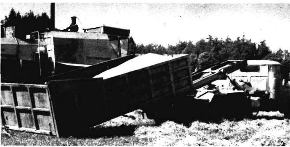
Bild 1. LKW Tatra 148 bei der Aufnahme eines Containers
