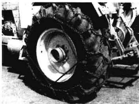
Bild 2. Spannen der Gleitschutzkette
