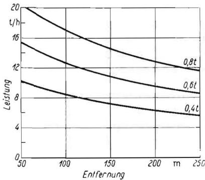
Bild 9. Erreichbare Leistung bei der KartoffelAuslagerung mit einem Gabelstapler in Abhängigkeit von der Transportentfernung und dem Schaufelinhalt (0,4 t, 0,6 t und 0,8 t)
