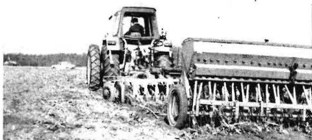
Bild 6. K-700 mit BDT-7 und angehängter schwerer Schleppe macht in einem Arbeitsgang ein abgeerntetes Kartoffelfeld saaftfertig
