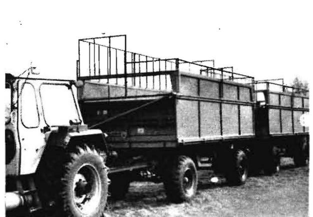
Herstellung und Montage des Ballenaufsatzes sind gering. Die Umrüstung des SHA 8 in die Form des volumenvergrößerten Grundaufbaus wird nur einmal ausgeführt. Für den Futtertransport kann dann der Grundaufbau mit den serienmäßigen Überblassschutzwänden des SHA 8 zusätzlich ausgerüstet werden.
