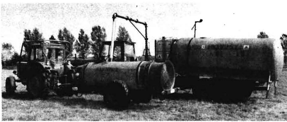
Bild 2. 2000-l-Sprühergerät Kertitox NA 20/4 und mobile Misch- und Befüllereinrichtung Mobimix
