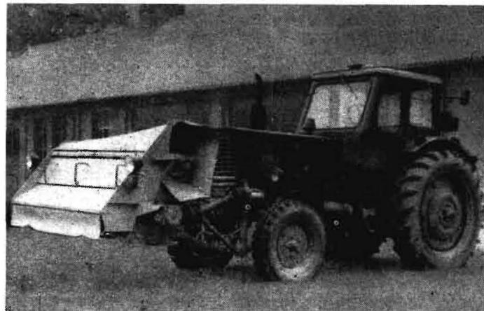
Bild 2. Frontanbau-Dreipunktsystem
