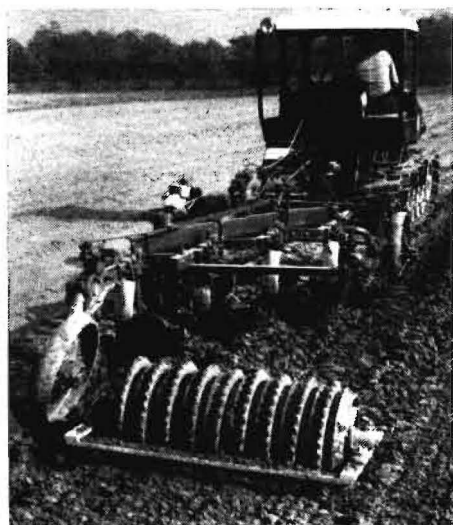
Bild 2. Anhäng-Beetpflug DV 30 mit Kettentraktor KS 07
