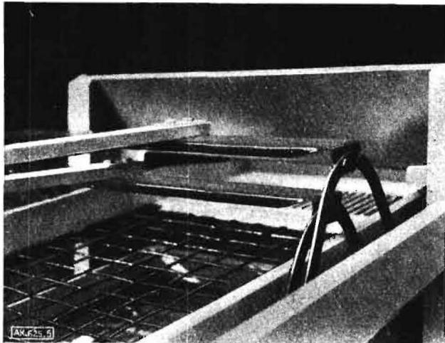
Bild 5 Zugstangen und Antriebstraversen
