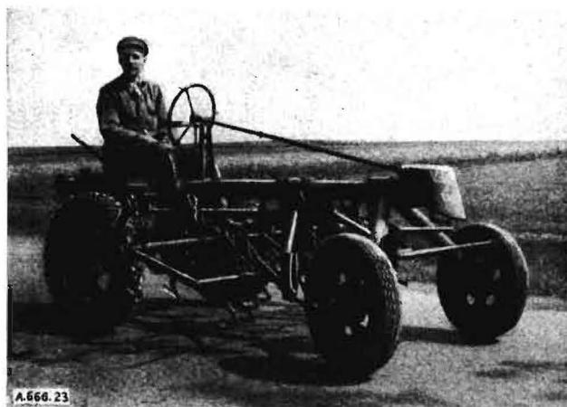
Bild 23 Geräteträger mit Hackrahmen und Parallelogramm in Transportstellung
